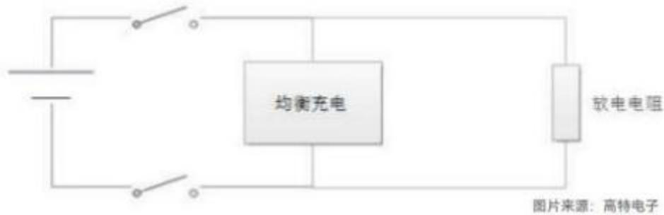
图6外界辅助型被动均衡放电+均衡充电技
